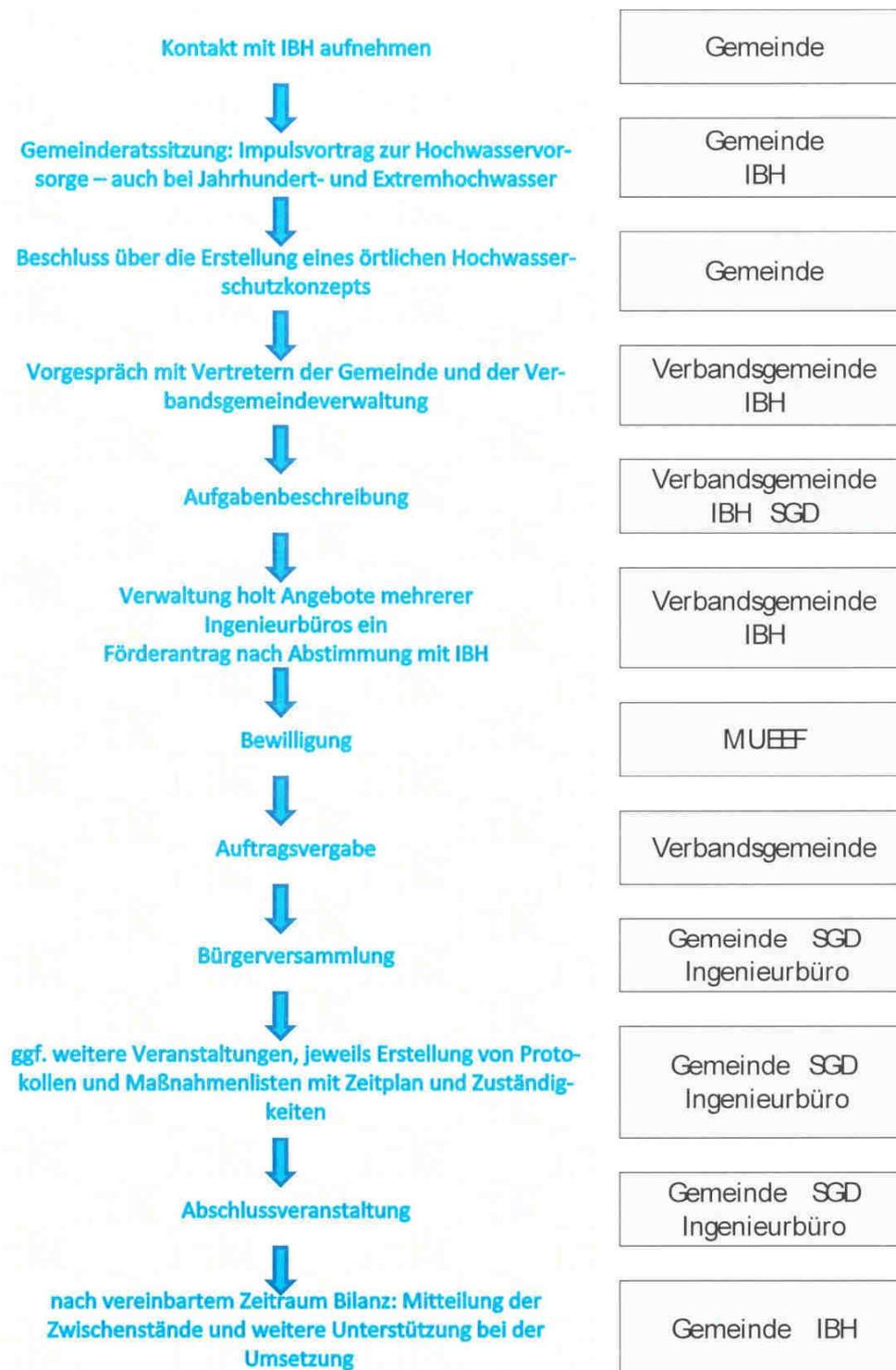
Abbildung 1: Ablaufdiagramm zur Erstellung eines örtlichen Hochwasserschutzkonzeptes nach IBH [8]
